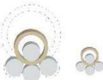
Боковые валки перемещаются максимально близко к центру верхнего вала, за счет чего обеспечивается наименьший внутренний диаметр готового изделия  $K=1,1$  к диаметру верхнего вала (у станков с линейными направляющими  $K=1,3-1,5$ ). Прямолинейный участок сокращается до 1,5–2,0 толщины материала (на станках с линейными направляющими прямолинейный участок составляет 3,0–5,0 толщины материала).
